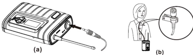
2. Collegamento del microfono headset: collegare il connettore del microfono in dotazione al jack di collegamento del trasmettitore (mostrato di seguito). Imposta lo stato operativo del trasmettitore nel sistema headset.
