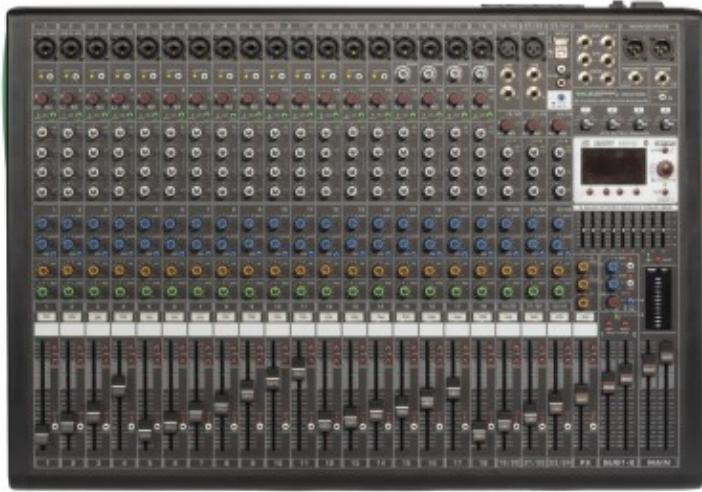
Mélangeur analogique compact avec DSP 32 bits et carte son full duplex intégrés, 99 effets, connectivité Bluetooth et lecteur multimédia. 4 groupes de sorties auxiliaires sélectionnables indépendamment, avec sélecteur matriciel. Égaliseur à 9 bandes sur le master. Alimentation phantom +48V.
