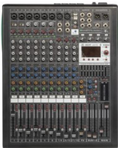
Mélangeur analogique compact avec DSP à 32 bits et carte son full duplex intégrés, 99 effets, connectivité Bluetooth et lecteur multimédia. 4 groupes de sorties auxiliaires sélectionnables indépendamment, avec sélecteur de matrice. Égaliseur à 9 bandes sur le master. Alimentation fantôme +48V
