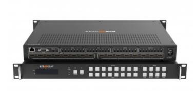
El procesador de videowall y matriz de conmutación BZ-MVS8X8-4K es una herramienta increíble que admite hasta ocho entradas y ocho salidas. La unidad puede admitir múltiples paredes de video de calidad comercial con calidad 4K HDR simultáneamente en varias configuraciones, como 1x2, 2x2 o 3x2, hasta 8 pantallas en total
