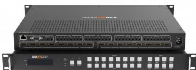
Der BZ-MVS8X8-4K Videowandprozessor und Matrix-Umschalter ist ein unglaubliches Werkzeug, das bis zu acht Eingänge und acht Ausgänge unterstützt. Das Gerät kann mehrere kommerzielle Videowände mit 4K-HDR-Qualität gleichzeitig in verschiedenen Konfigurationen wie 1x2, 2x2 oder 3x2 bis zu insgesamt 8 Displays unterstützen.
