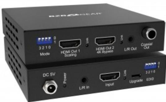
Der BG-UHD-SC1X2 ist ein 4K-18-Gbit/s-HDMI-Splitter mit integriertem Skalierer, der speziell für Installationen entwickelt wurde, die die Verteilung einer einzelnen 4K-Videoquelle auf mehrere Displays mit eingeschränkter Videoauflösung erfordern.
