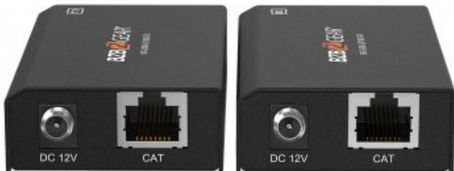
Der BG-USB-LR100 erweitert den USB 2.0-Anschluss des PCs auf Entfernungen von bis zu 100 Metern mit einer Datenübertragungsgeschwindigkeit von bis zu 480 Mbps über ein Netzwerkkabel.
